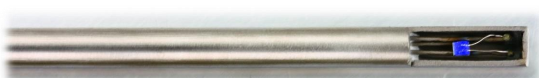
采用内埋式焊接工艺的铠装热电阻，测量端元件焊接长度约为 20mm，无对接焊缝
