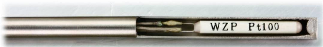
采用对接式焊接工艺的铠装热电阻，测量端元件焊接长度约为 50mm，有对接焊缝
